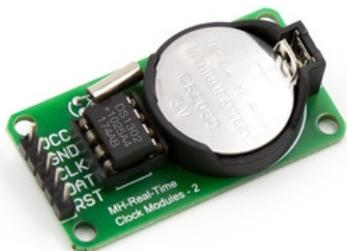
DS1302 – это микросхема реального времени. Она обеспечивает ход времени, даже когда основное устройство отключено от питания.
