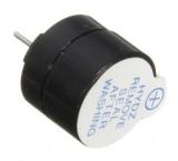
Пьезо-пищалка, воспроизводящая звуки на частоте 2 кГц. Для его работы достаточно подать на него напряжение 3 – 5 В.
