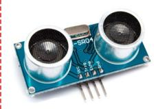
Модуль генерирует звуковые импульсы на частоте 40 кГц и слушает эхо. По времени распространения звуковой волны туда и обратно можно однозначно определить расстояние до объекта.
