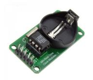
DS1302 – это микросхема реального времени. Она обеспечивает ход времени, даже когда основное устройство отключено от питания.
