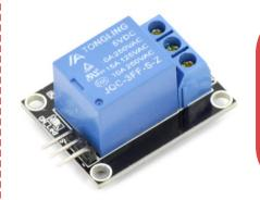
Данный модуль предназначен для управления мощным током, как постоянным, так и переменным.
