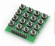
Объединение в один модуль нескольких тактовых кнопок упрощает конструкцию панели управления прибора и экономит порты Arduino или микроконтроллера.
