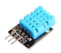
Модуль датчика DHT11 предназначен для снятия данных о температуре и влажности окружающей среды.
