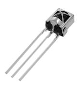
Инфракрасный датчик VS1838B, работающий на частоте 38 кГц. Применяется в связке с ИК пультом.
