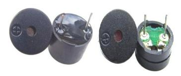
Пассивным нужен входной сигнал звуковой частоты, а активным — только напряжение.
