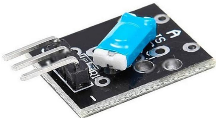
**KY-020** – это переключатель, срабатывающий от наклона модуля, имеющий цифровой интерфейс. При наклоне датчика в одну сторону контакты «-» и «S» замыкаются с помощью встроенного небольшого металлического шарика, при наклоне в другую размыкаются. Модуль позволяет определять **только два положения** и не измеряет угол наклона.
