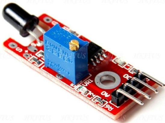
**Датчик пламени** реагирует на инфракрасное излучение и наиболее чувствителен к длинам волн **от 760 нм до 1100 нм**. Этот модуль имеет два выхода – цифровой и аналоговый. На плате имеется 2 светодиода – индикации питания и индикации выхода с компаратора.
