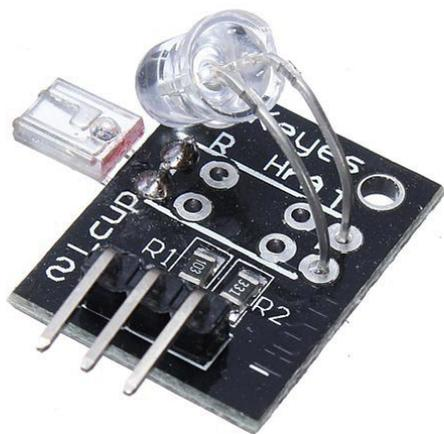
**KY-039** состоит из инфракрасного светодиода (LED) и фототранзистора, с помощью которых можно измерять сердцебиение в пальце. Монитор сердечного ритма работает следующим образом: палец должен быть расположен между IR-светодиодом и фототранзистором, который получает поток инфракрасного излучения.
