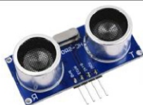
УЗ ДАТЧИК РАССТОЯНИЯ HC-SR04
