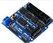
ПЛАТА РАСШИРЕНИЯ SENSOR SHIELD
