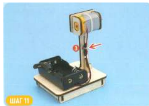
Шаг 11 Соберите и зафиксируйте хомутом провода на стойке
