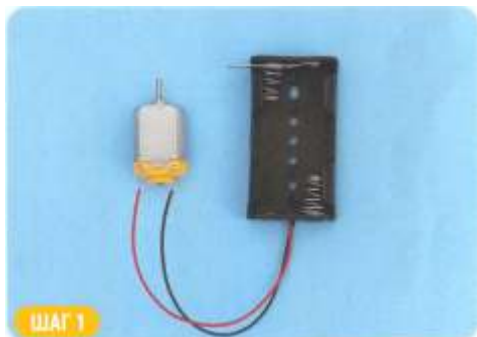
Шаг 1 Прикрутите провода отсека к клеммам двигателя
