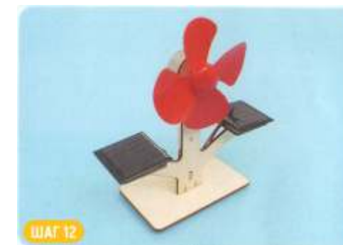
ШАГ 12 В завершение наденьте на вал двигателя пластиковый винт
