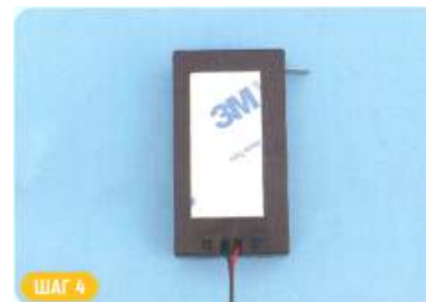
Шаг 4 Приклейте на обратную сторону отсека двусторонний скотч
