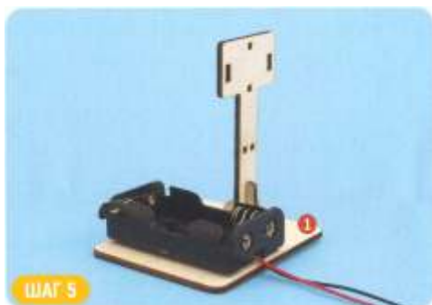
Шаг 5 Приклейте на основание батарейный отсек
