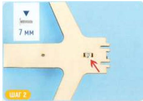
ШАГ 2 Зафиксируйте уголок винтом
