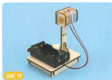
Шаг 10 Зафиксируйте двигатель хомутом
