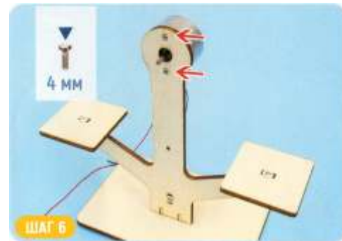
ШАГ 6 Закрепите винтами двигатель на вершине стойки
